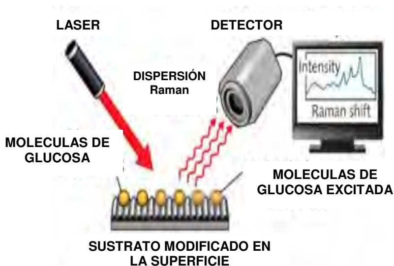
Figura 12.- Esquema detección Raman (US Dinish et al., Biosensors and Bioelectronics 26, 1987-1992 (2011))
