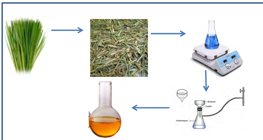
Figura 16.- Diagrama de flujo para la obtención de extracto de Cymbopogon citratus
